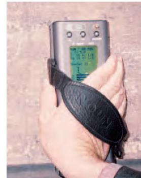
Utilisation d'un appareil portable à fluorescence X, XRF permettant de mesurer le plomb (mg/cm<sup>2</sup>)
