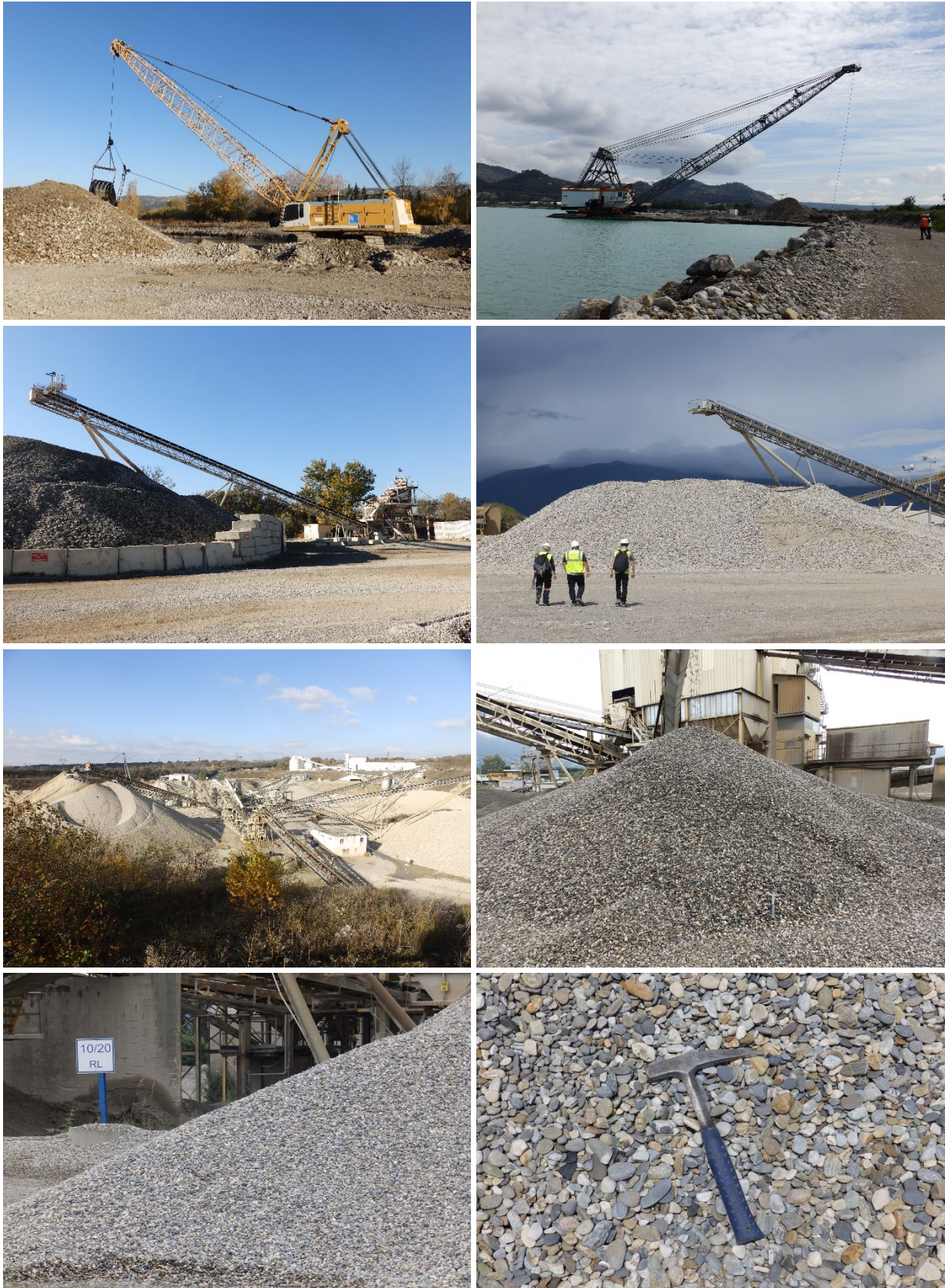
Figure 5 : Prélèvements constitution de pré stocks (Ligne 1), ; Tapis d'alimentation de stocks primaires (Ligne 2) ; Installations de criblage (Ligne 3) ; Stocks commerciaux (Ligne 4)
