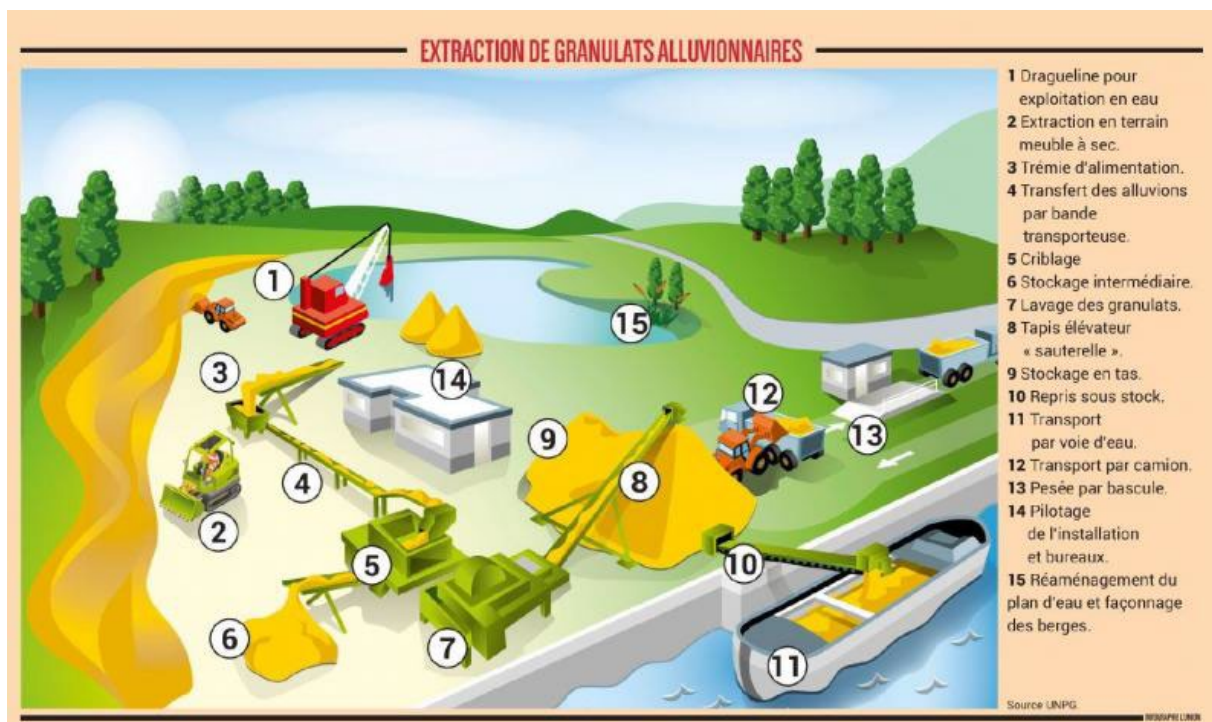
Figure 4 : Schéma illustrant l'extraction de granulats alluvionnaires (Source : UNPG)
