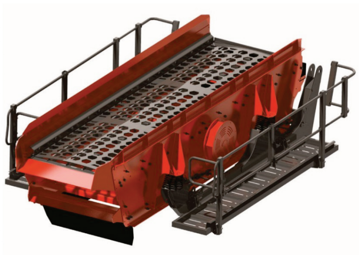
Figuur 14: Zeefdek met punch plate (Herwijnen Machinery, 2022)
