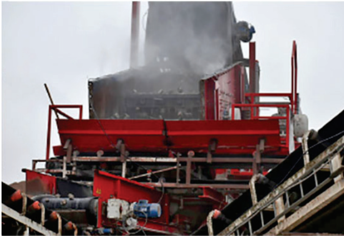
Figuur 11: Verneveling op zeefinstallatie (Recyclepro, 2020)
