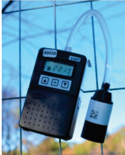
Figuur 35: Pompje met filter voor luchtmeting op asbestvezels ihkv codex welzijn op het werk (BB Risk Solutions, 2023)
