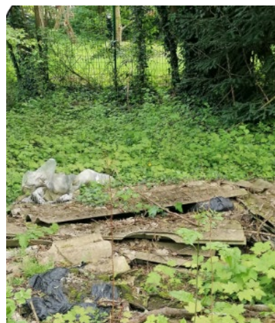
Figure 40 : Tôles ondulées en fibrociment dans un dépôt illégal (Ecogeos)
