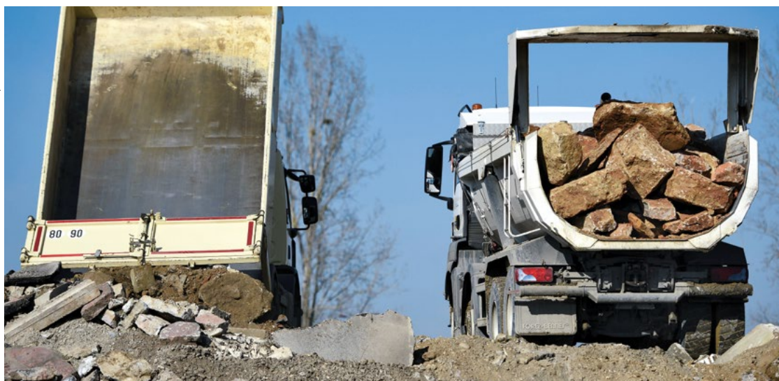
■ Figure 25. Déchargement de déchets minéraux inertes à recycler
