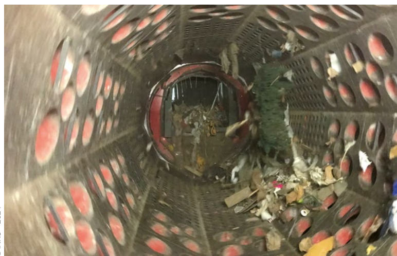
Figure 12. Intérieur d'un crible cylindrique (Trommel)
