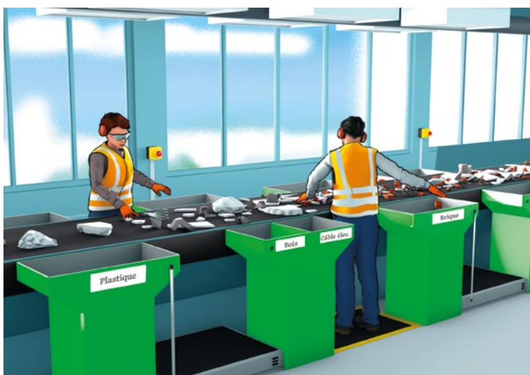
■ Figure 16. Exemple de cabine de tri bilatéral limitant à deux le nombre de consignes de tri par opérateur
