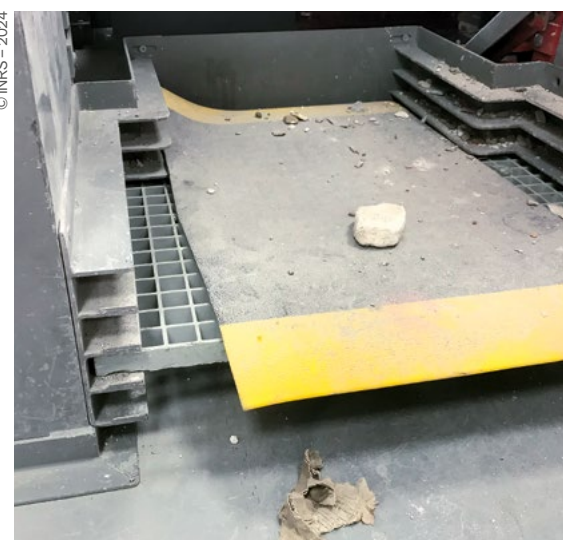
■ Figure 17. Plateforme d'accès au tapis convoyeur de hauteur réglable
