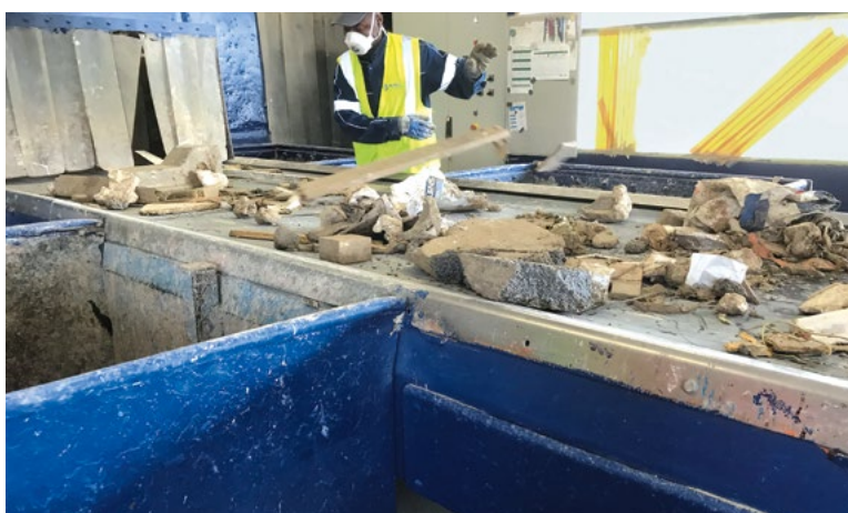
■ Figure 16. Exemple de cabine de tri bilatéral limitant à deux le nombre de consignes de tri par opérateur
