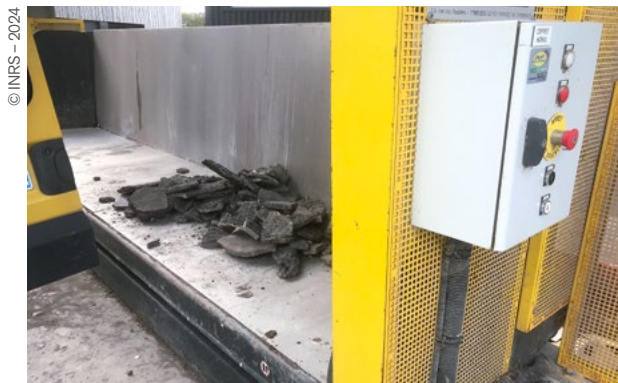
■ Figure 9. Plateforme avec commande déportée utilisée en déchèterie des artisans et des particuliers
