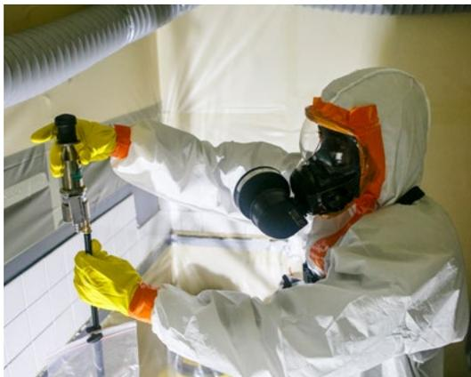
■ Figure 5. Préleveur installant un dispositif de prélèvement environnemental
