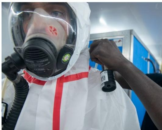
Figure 3. Opérateur équipé de dispositifs de prélèvement individuel
