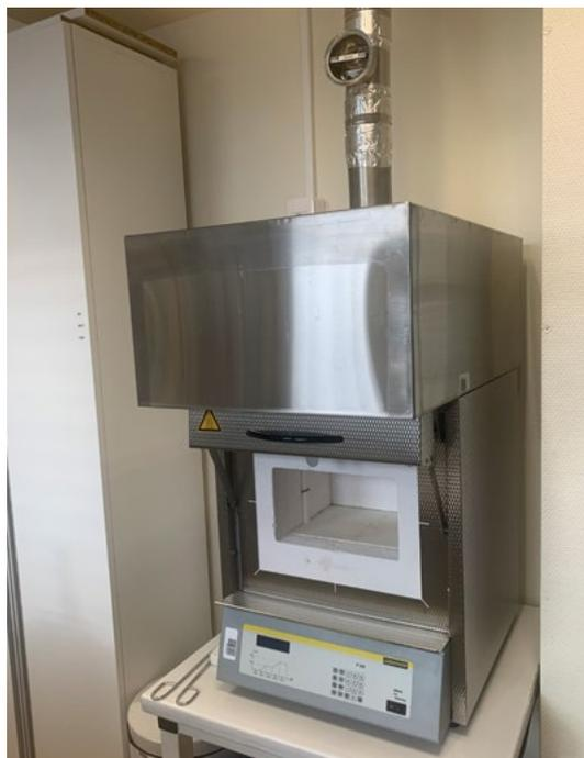
Figure 10. Four à moufle équipé d'un dispositif d'aspiration des fumées à l'ouverture du four
