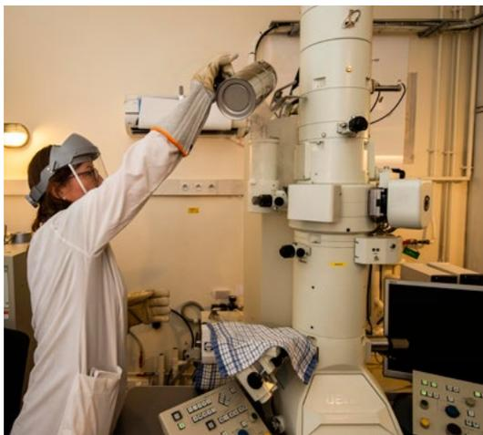
Figure 13. Remplissage d'azote liquide
